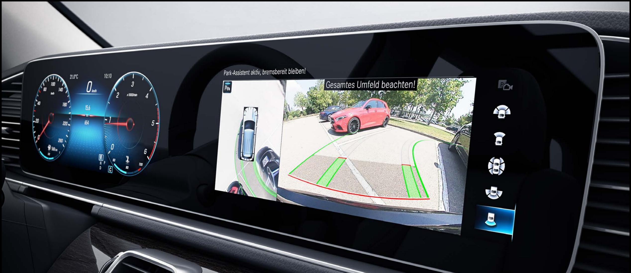
360도 모니터링 기능을 제공하는 특별한 주차 서비스. 360° 카메라가 탑재된 액티브 주차 어시스트 파크트로닉이 비어 있는 주차 위치나 표시된 주차 공간을 감지합니다. 차량 방향과 버드뷰 화면을 통해 주차 및 출차가 편리해집니다. (기본사양)
