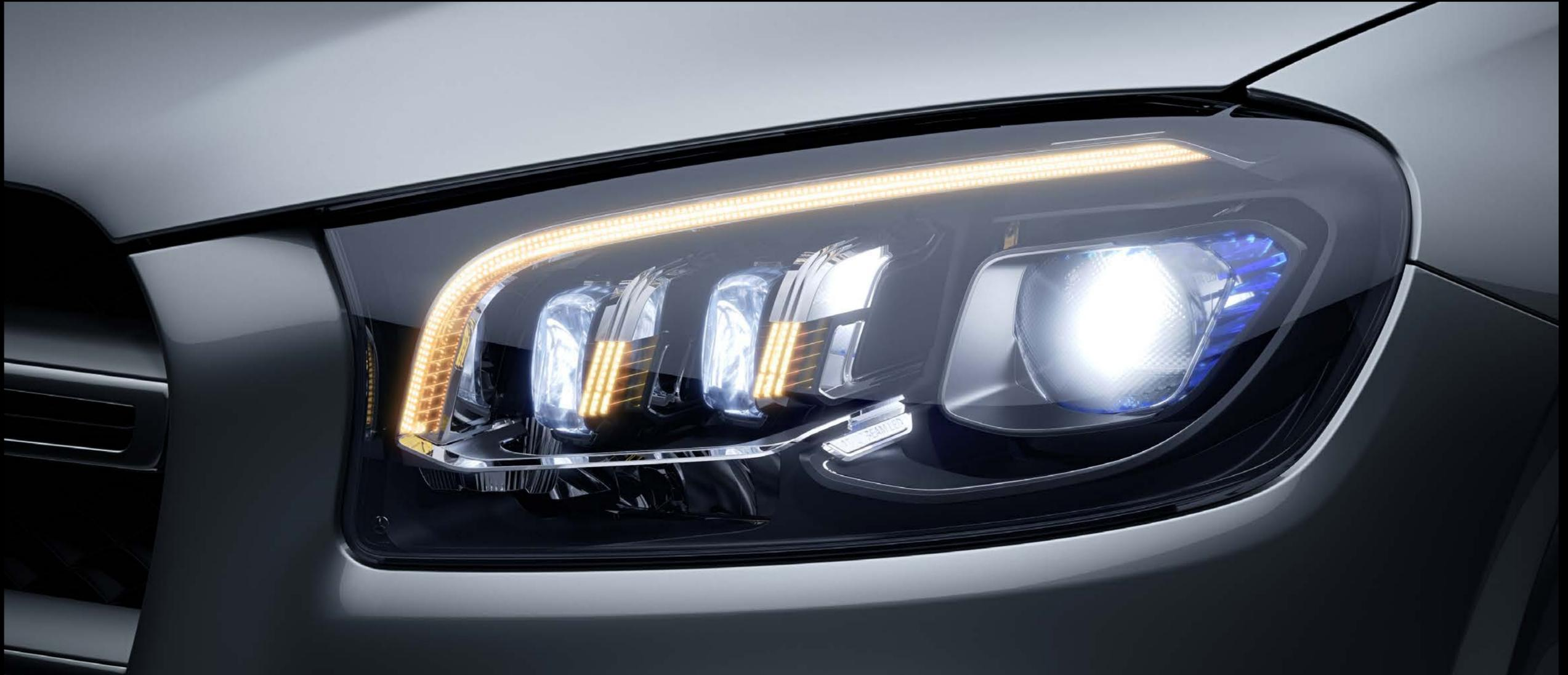
개별 조절 가능한 LED가 장착된 적응형 멀티빔 LED 헤드램프는 교통 상황에 따라 반응합니다. 메인 빔은 반대편 도로에서 주행하는 차량을 비추지 않기 때문에 상대 차량 운전자의 눈부심을 최소화합니다. 다른 차량의 불빛이 없을 경우 울트라 레인지 하이빔이 미치는 거리는 650미터까지 증가합니다. 코너링 라이트 및 액티브 라이트 기능도 시야를 충분히 확보해 줍니다. (기본사양)
