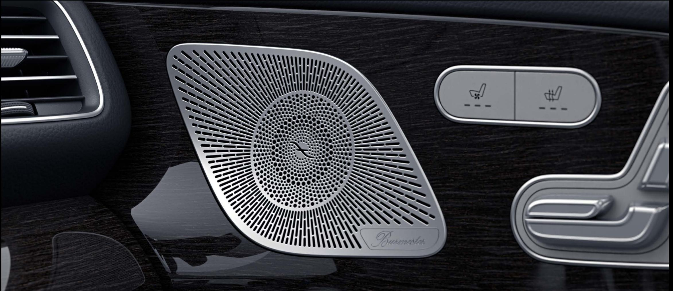
13개의 고성능 스피커와 590와트의 시스템 출력은 Burmester® 서라운드 시스템을 나만의 오케스트라처럼 지휘할 수 있는 하이엔드 경험을 만들어냅니다. 사운드는 다섯 가지 사전 설정으로 조정할 수 있으며, 각 좌석에 대해 개별적으로 조정 가능합니다. 또한, 노이즈 보상 시스템(VNC)은 주어진 주행 상황에 맞춰 소리를 동적으로 조정합니다. 스피커의 스타일리시한 디자인은 소리가 들리지 않을 때에도 프리미엄 클래스를 보여줍니다. (기본사양)
