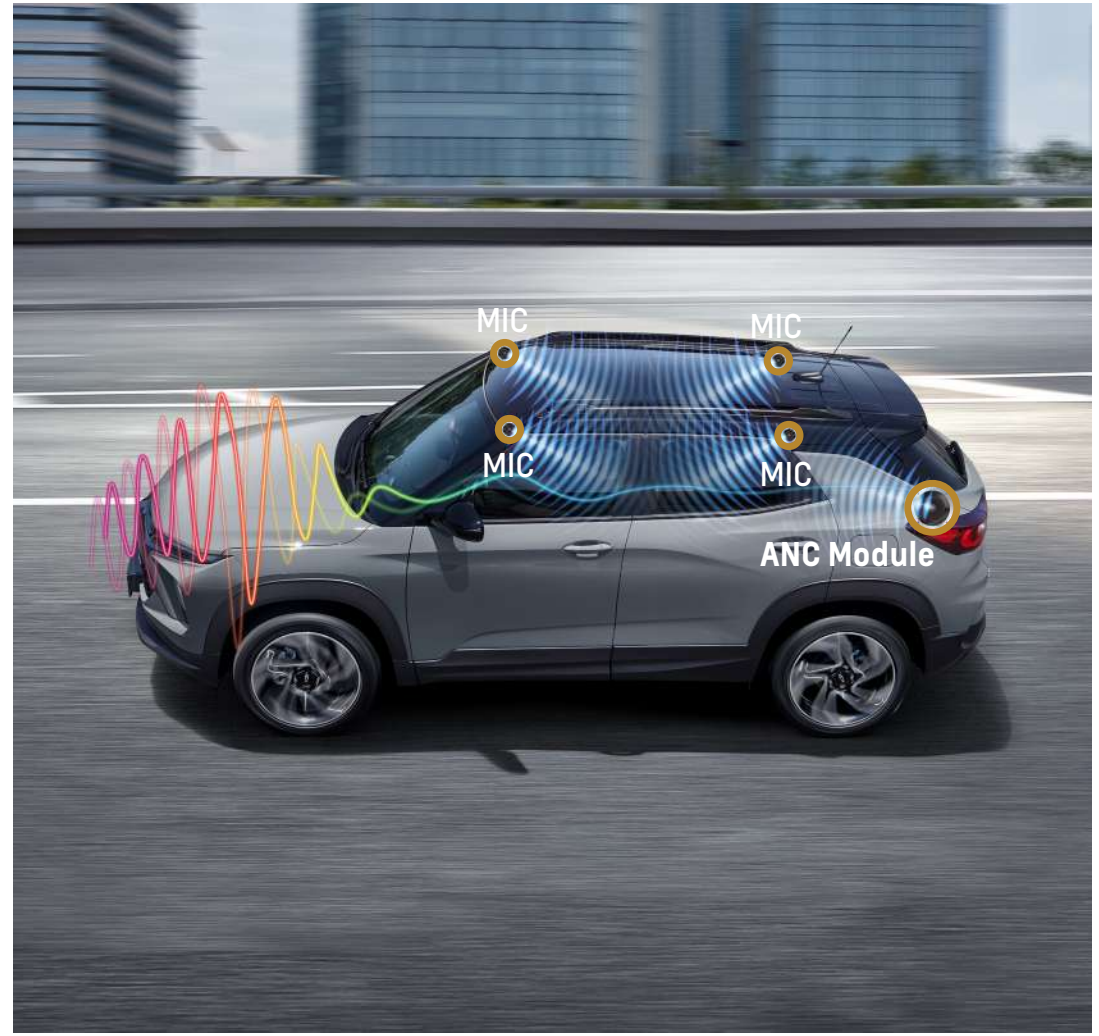
어댑티브 크루즈 컨트롤 (정차 & 재출발) 액티브 에어로 셔터 액티브 노이즈 캔슬레이션 (ANC)
