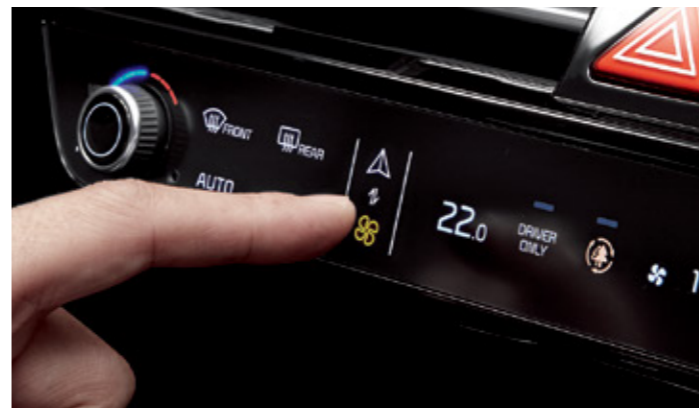
인포테인먼트 / 공조 전환 조작계 조작 패널 중앙의 버튼 하나로 인포테인먼트 주요 기능과 공조 시스템을 쉽게 오가며 통합 컨트롤할 수 있습니다. 더불어 직관적 조작이 필요한 버튼 외에 모든 버튼을 터치 방식으로 적용해 혁신적 이미지를 구현했습니다.
